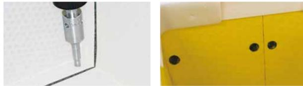
超音波でプラパール同士を溶かし、接着させる加工です。リベットよりも強度は劣りますが、他素材を使わないので、美観性に優れています。外観を重視する梱包箱などに最適です。
