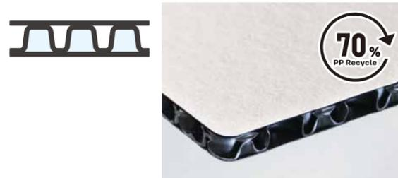
円柱状にしたシートと上下2枚のシートを熱溶着させ、空気を密封した3層構造の中空積層板です。厚みは5種類。軽く加工しやすい3mm厚、標準で5色のカラーがある5mm厚、扱いやすい6mm厚、剛性が高い9mm、10mm厚です。また、目付重量を選ぶことにより製品の強度のご要望に対応できます。これらの選択肢により、お客様の用途に合った製品をご提案させていただくことが可能です。
